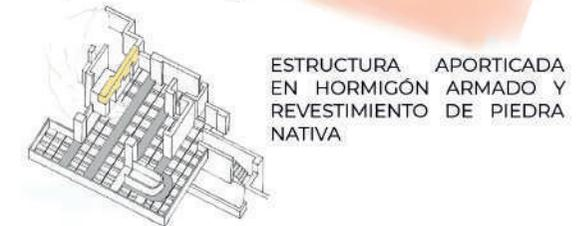
ESTRUCTURA APORTICADA EN HORMIGÓN ARMADO Y REVESTIMIENTO DE PIEDRA NATIVA
