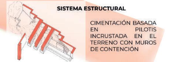
CIMENTACIÓN BASADA EN PILOTIS INCRUSTADA EN EL TERRENO CON MUROS DE CONTENCIÓN
